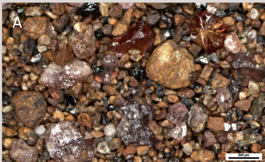
Obr. 5. Vzhled těžké frakce separované z mezní hmoty konglomerátů, vzorek HZDEJ 2 ze Stradonické rokliny pod Zdejcínou. A – magnetická frakce obsahuje dominantně limonit a granát. B – vzorek, nemagnetická frakce obsahuje rutil, zirkon a ojediněle zlato. Foto T. Sidorinová.
